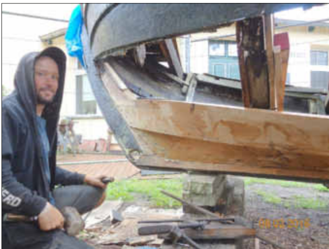
Herr Jens Lochmann hier bei Arbeiten an der Stevenspannung (Kiel bereits saniert), auch bei einem Regenschauer wird weiter gewerkelt.
