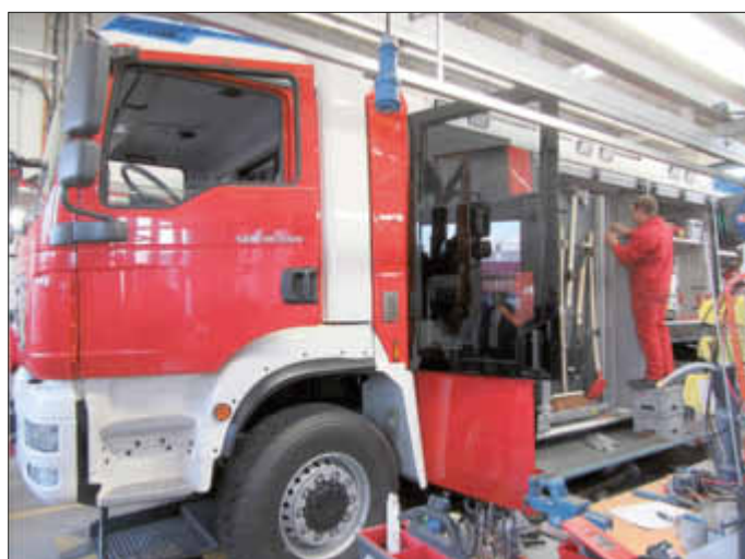
Einbau der Gerätefächer
