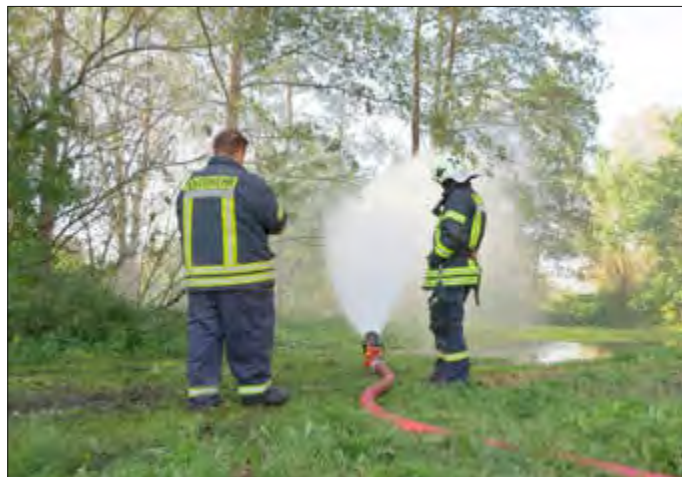
Das oszillierende stationäre Strahlrohr im Einsatz.
