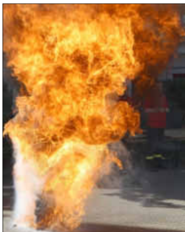
Dieses Feuer entsteht, wenn man brennendes Öl mit Wasser löschen will.
